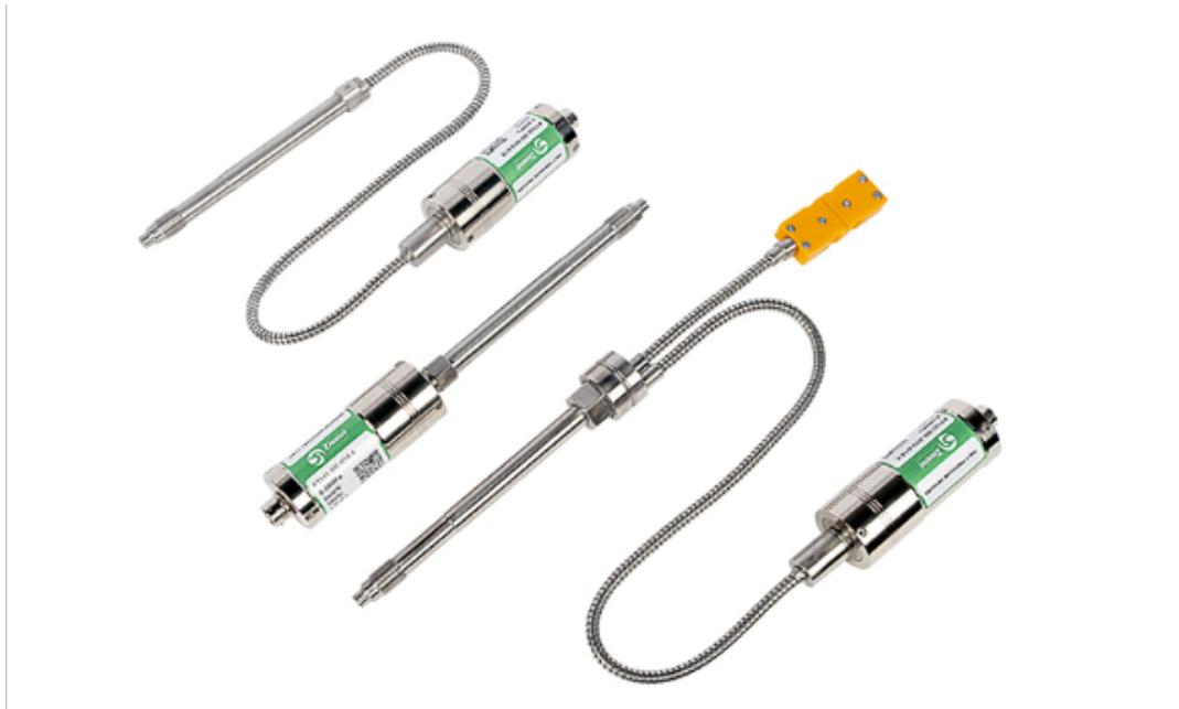
**介质温度：**由于高温型压力变送器的信号是通过电子线路部分转换的,所以一般情况下,高温型压力变送器的测量介质温度为-30到+100度。如果温度过高,我们一般采用的是冷凝弯来冷却介质。这样相对让厂家特地为你生产一个耐高温的压力变送器的成本会降低很多。**测量介质：**一般我们测量的是相对比较清洁的流体,我们就直接采用标准的压力变送器就可以了。如果你所测量的介质是易结晶的或粘稠的,我们一般采用的是外置膜片的或和化学密封共同使用。这样会有有效的阻止介质堵住压力测量孔。**其他：**在确定上面的六个参数之后还要确认你的高温型压力变送器的过程连接接口以及压力变送器的供电电压。如果在特殊的工奖品场合下使用还要考虑防爆等级。无纺布非织造、建筑包装材料等设备的高温熔体、流体、气体介质的压力测量。浙江齐亚斯高温熔体压力传感器模型
